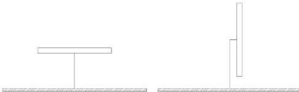
Рис. 1 - Вертикальна і горизонтальна орієнтація сонячних панелей
