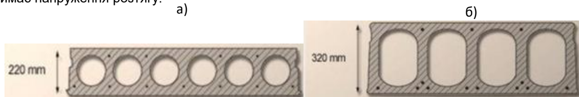
Рис.1 Види багатопустотних плит перекриття у перерізі: з круглими порожнинами (тип ПК)-а, з овальними порожнинами – б
