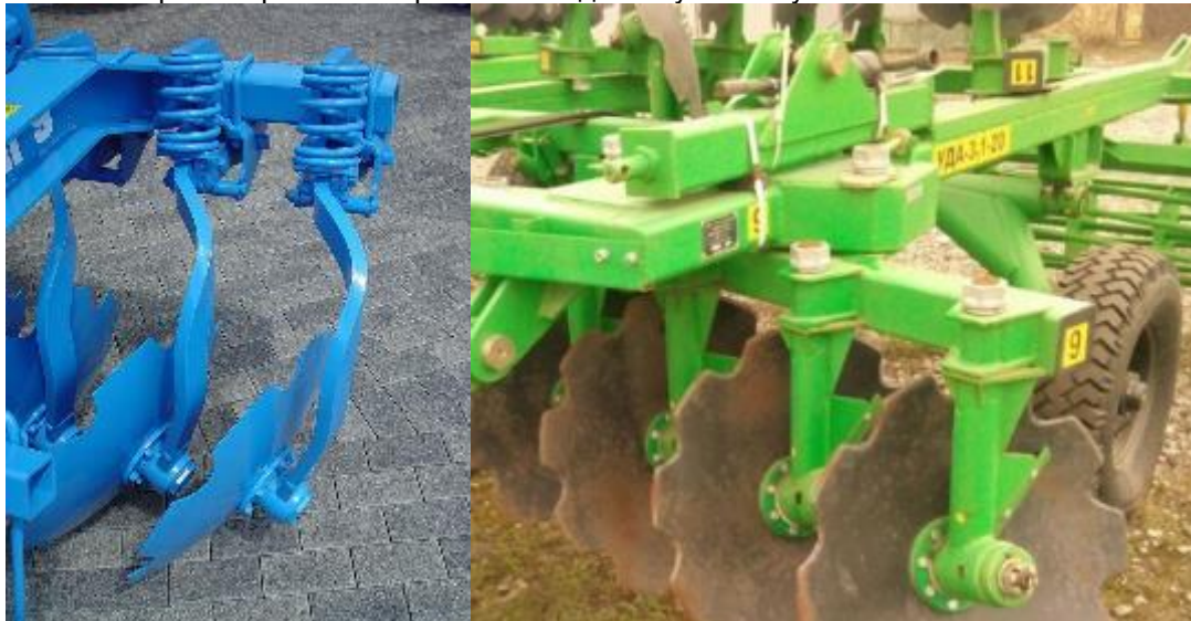
Рисунок 1. Види кріплення стоек дискових борін
