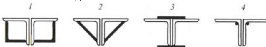
Рисунок. 1. Підсилення металевих елементів ферм за допомоги кутиків, стержнів та пластин.
