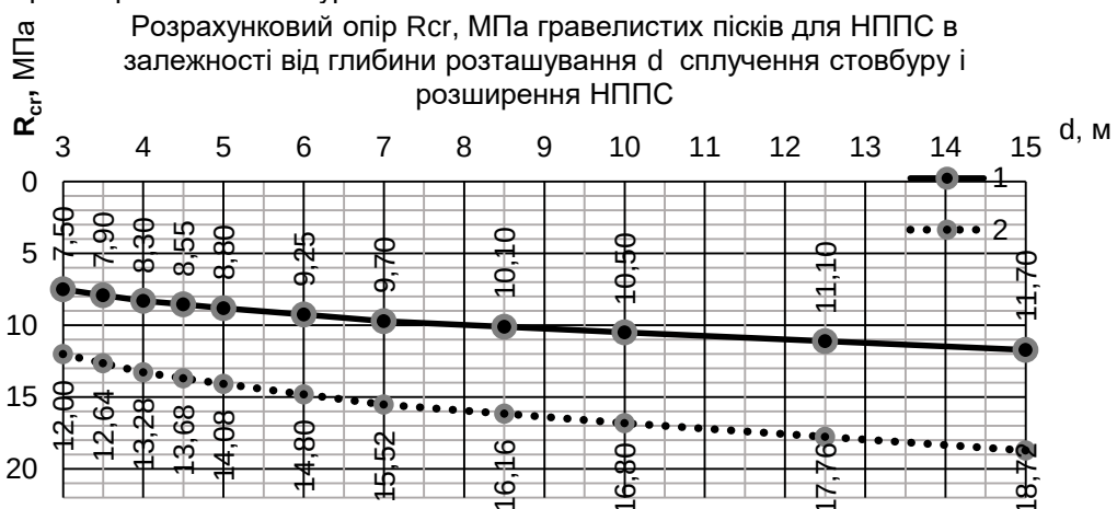
Рис.1. Розрахунковий опір R_{cr} гравелистих пісків на глибині d сплучення зі стовбуром
