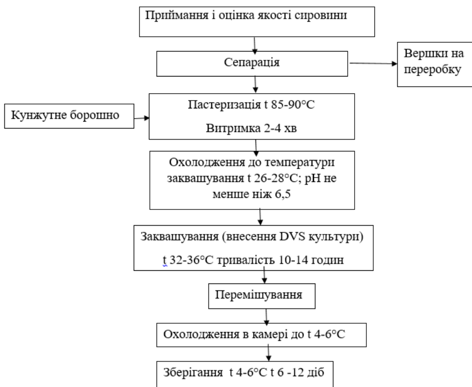
Рис. 1. Принципова схема виробництва кефіру із кунжутним борошном
